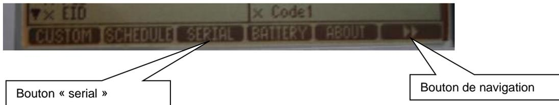
5) A l'écran de configuration série, assurez-vous que les paramètres sont tels qu'illustrés sur l'image suivante et ensuite cliquez sur le bouton « B.Tooth) au bas à droite pour accéder à la configuration bluetooth du XR3000 :
